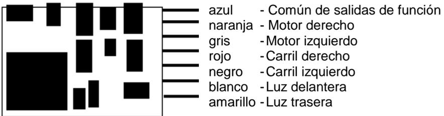
Figura 2. Conexiones
